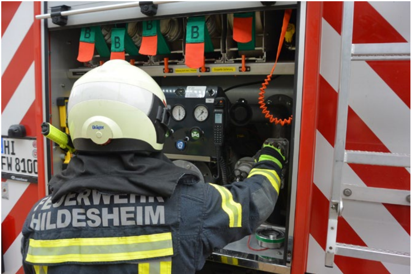
Alles im Blick, alles im Griff: Der Maschinist an seinem Arbeitsplatz an der Fahrzeugpumpe (Foto: Philip Ossenkopp)
